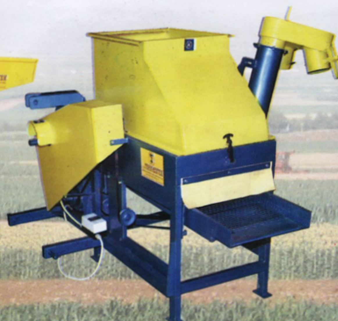
Krunjač na električni i traktorski pogon (3,5 do 4 t/h)
